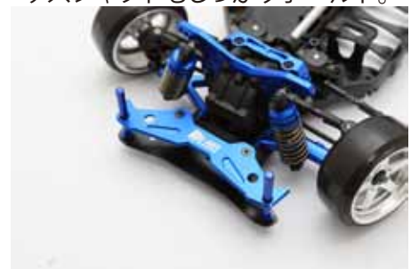
アルミボディマウントとの使用でボディをガッチリホールド!!
