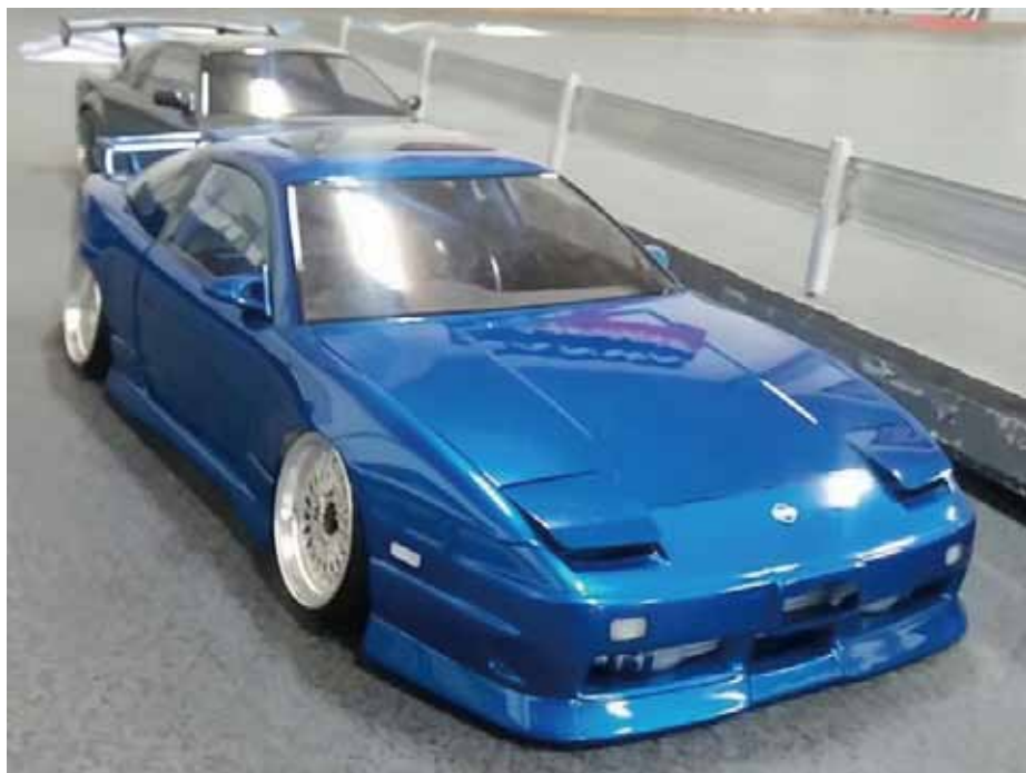
0.5mmポリカを採用してフェンダーとのマッチングをはかっています。
