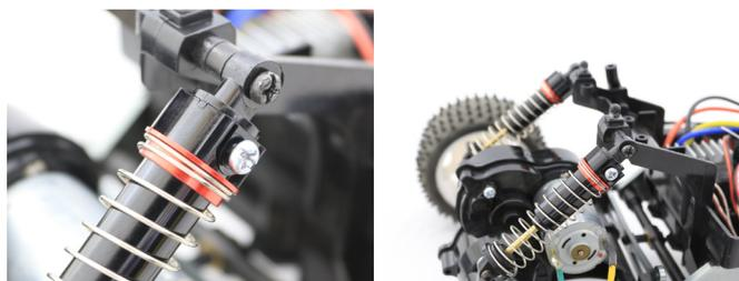
スプリングシートを装着することで Spring がシリンダーに接触することを防ぎ、本来の Spring の性能を発揮してくれます。
