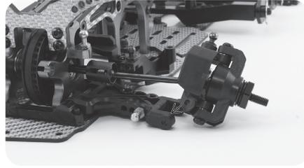
※セットスクローをねじ込みすぎると樹脂部分のネジ山が破損する場合がありますのでご注意ください。
