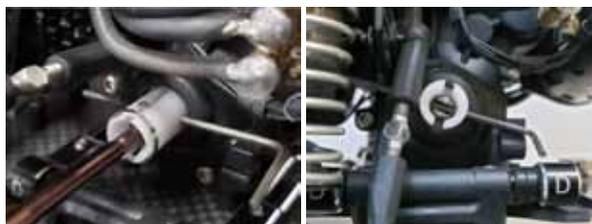
・写真のように1.5mmの六角レンチで固定し反対側のタイヤを回すことで外部から確実に簡単にデフのトルク調整が可能になります。
