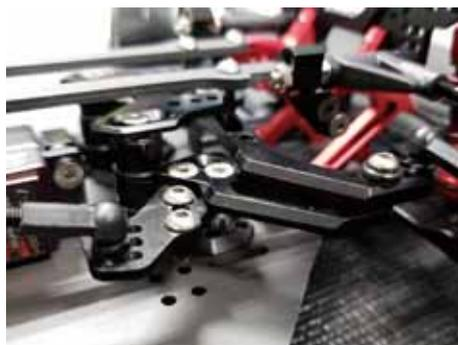
●ART2364 RX ステアリングワイパーセット Ver.4 をご使用の方へのステアリングクランクの強化とアッカーマン調整幅を増やしたワイパーベースセットです。
