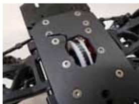
1.5mmのL型レンチでデフスクリューをロックして反対側のタイヤを回すことで簡単にトルク調整が可能!
