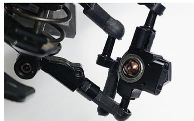
スペーサーを使わないでナックル高さ調整することでナックル強度を確保できます
