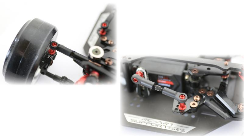
注：ギリギリまでピロボールとボールエンドのガタを減らしているため動きが重い場合はボールエンドリマーでの調整をお勧めします。
